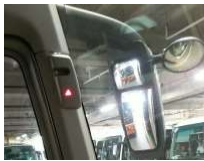
【左側ピラー警告ランプ点灯時】
